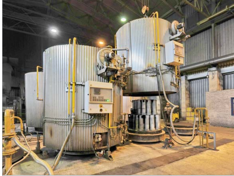
Когда-то термообработка была слабым звеном в технологической цепи изготовления корундографитовой продукции. Сейчас на участке уже десять колпаковых печей, позволяющих своевременно выполнять обжиг сформованных изделий.
