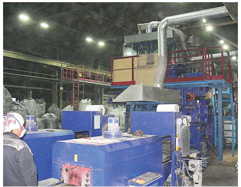
Линия по производству лёточных масс с новыми вытяжными системами.
