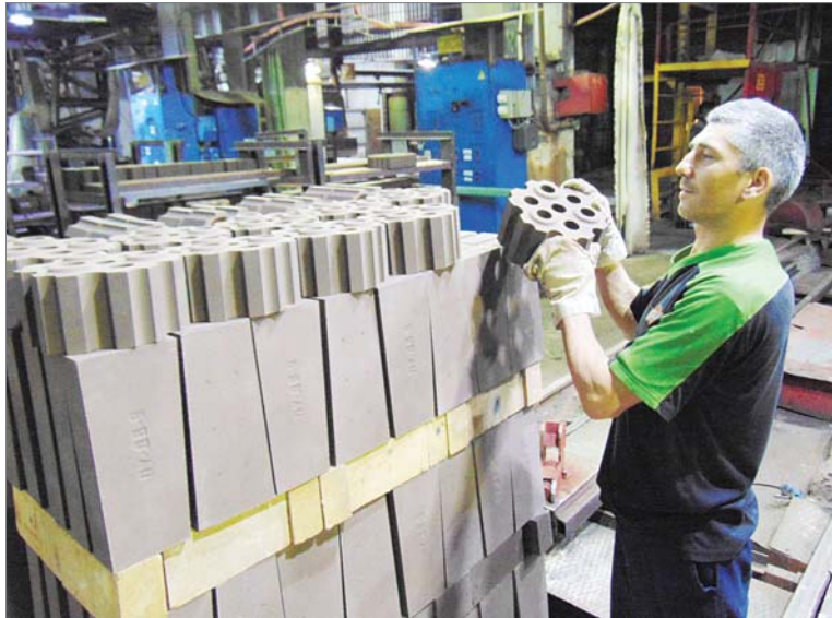
Сделанную на прессоформовочном участке продукцию садчик Рафаэль Ахтаров укладывает для дальнейшей загрузки в туннельный вагон.
