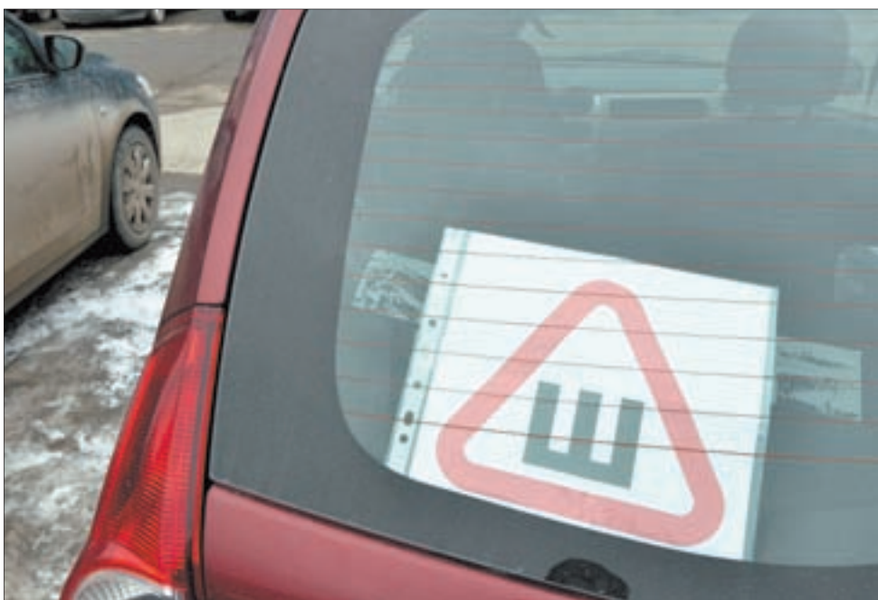
КАК ДОЛЖЕН ВЫГЛЯДЕТЬ ЗНАК «ШИПЫ». По ГОСТу, это равносторонний треугольник белого цвета вершиной вверх с каймой красного цвета, в который вписана буква «Ш» черного цвета (сторона треугольника — не менее 200 мм, ширина каймы 1/10 стороны).
