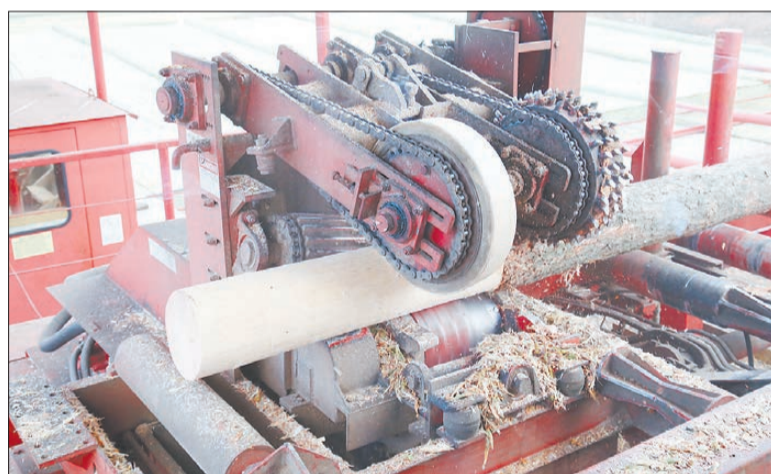
Запуск американской линии по производству опор ЛЭП почти полностью исключил ручной труд и увеличил производительность. Фото Павла Шабельникова
