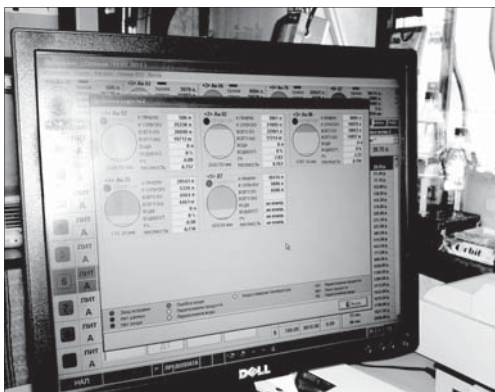
Оператор проверяет количество топлива и отсутствие воды в емкостях. Данные об этом высвечиваются на экране монитора компьютера.
