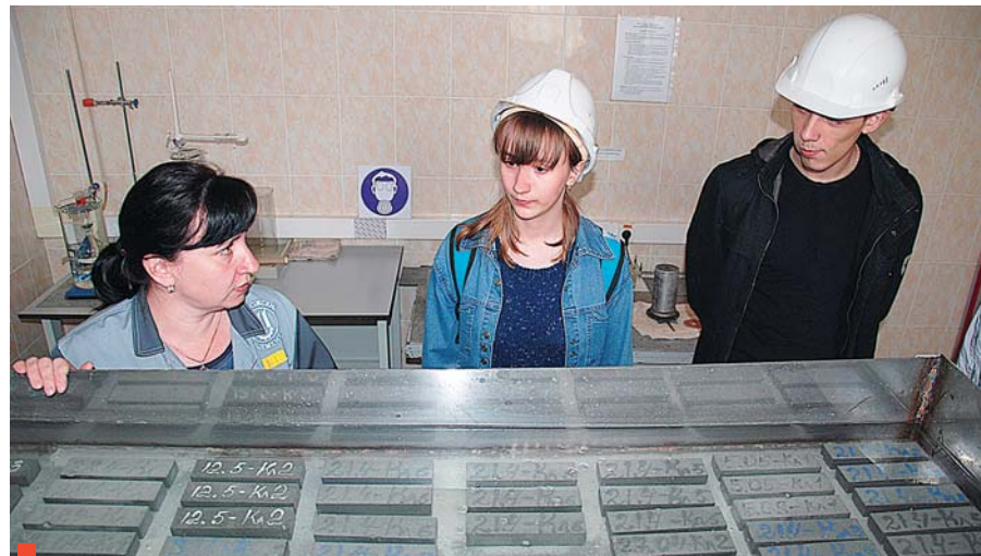
Перед испытаниями пробники цемента замачиваются в ванне с водой
