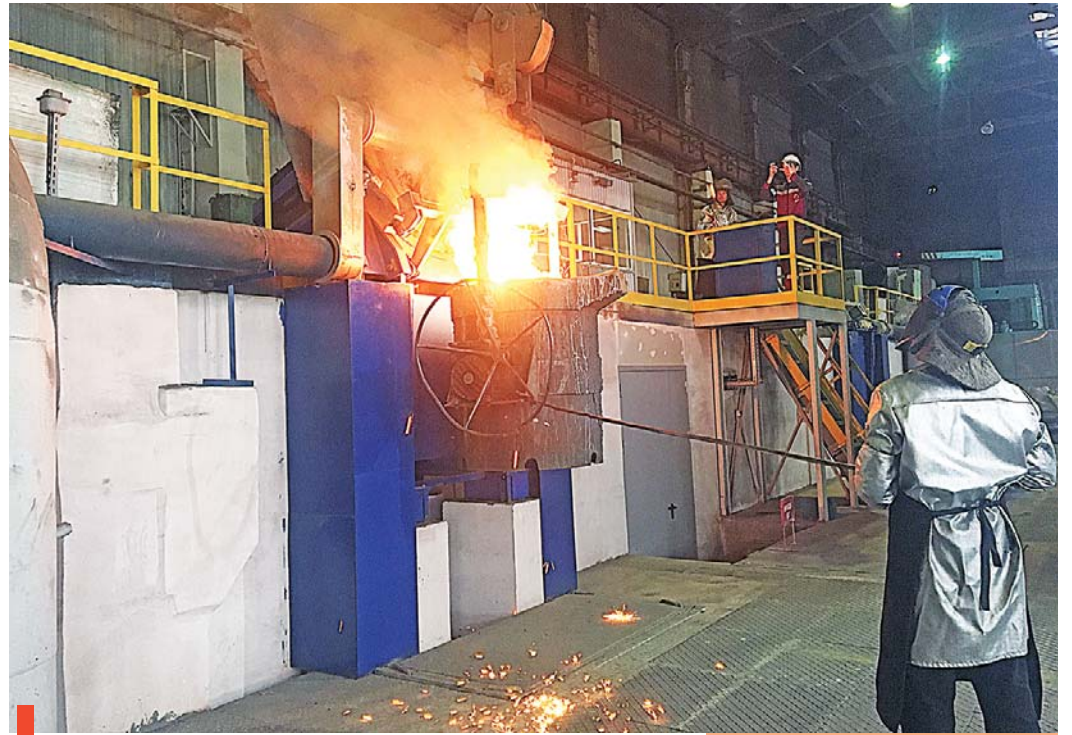
Плавка на индукционной печи EGES
