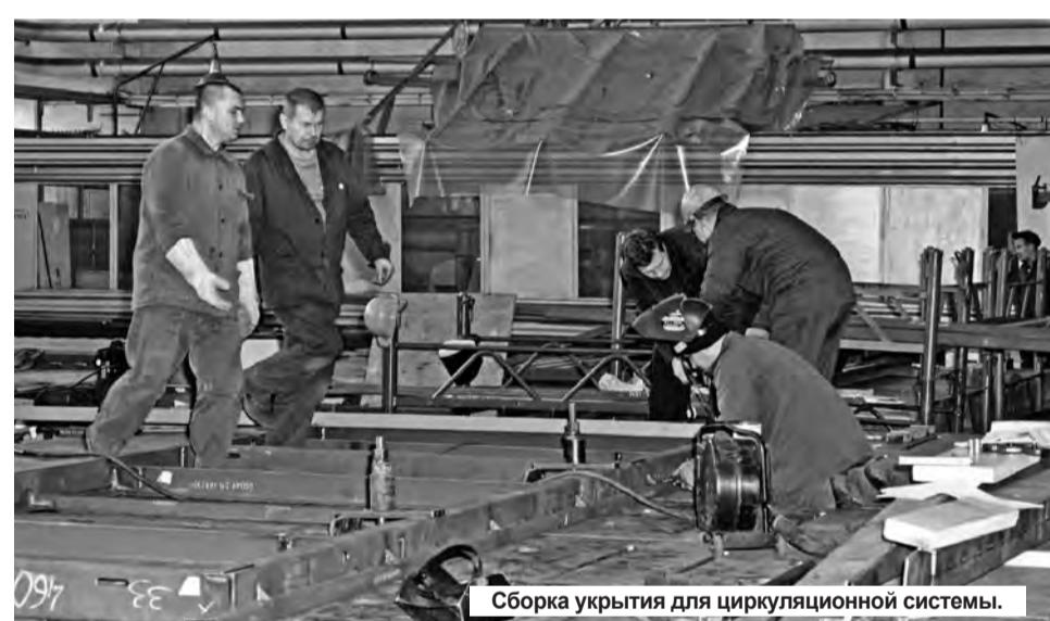
Сборка укрытия для циркуляционной системы.
