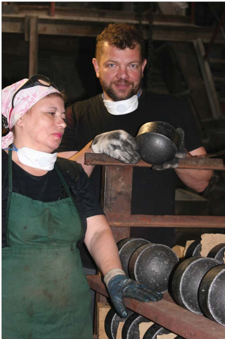
Сергей Ковалёв и Наталья Мясникова формируют огнеупорные шары, вес каждого изделия — 3 килограмма 700 граммов.
