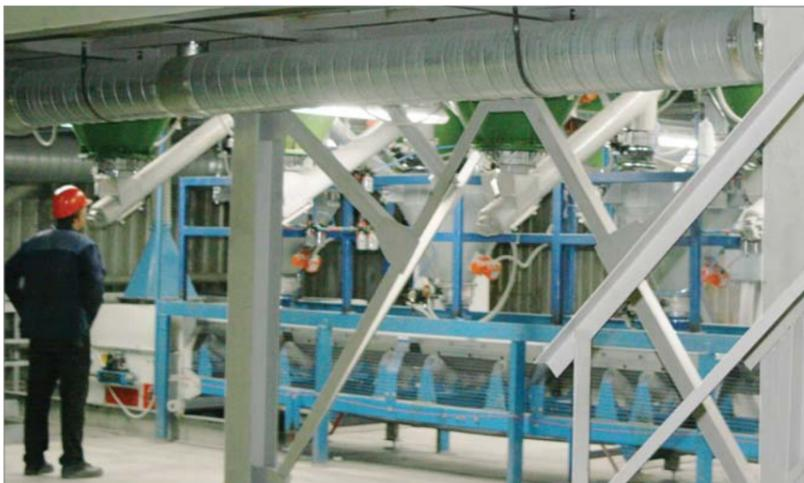
Новая линия дозирования лёточных масс обеспечивает более высокую производительность.
