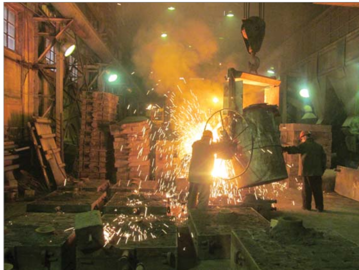
Горячий металл через горнило печи выливается в чайниковый ковш, а затем сталевар и его подручный разливают огненную массу по формам.
