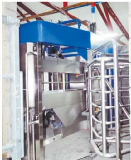
В специальных камерах установлены роботы-дояры на ферме в с. Кулики.
