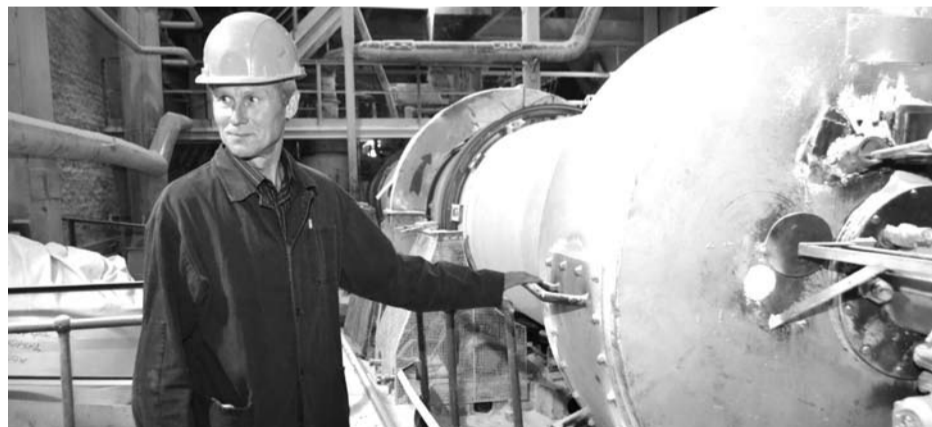
Во вращающейся печи ЦМП выжигаются примеси из периклаза. Этим процессом руководит обжигальщик Леонид Быков.
