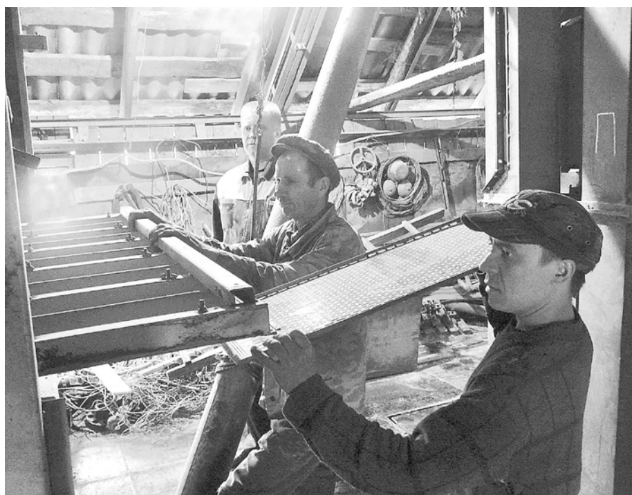
Замену решет в КЗС проводят работники КХ «ИП Степанов О.Н.» А.Г. Вольхин, Н.А. Волегов и Ю.Н. Шанаурин.
