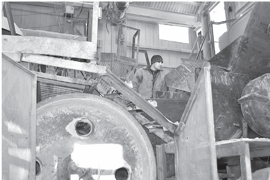
Любое оборудование нуждается в ремонте для выпуска качественной продукции. Сварщик «КСМ» Антон Бубеничиков производит осмотр щековой дробилки перед ремонтными работами.
