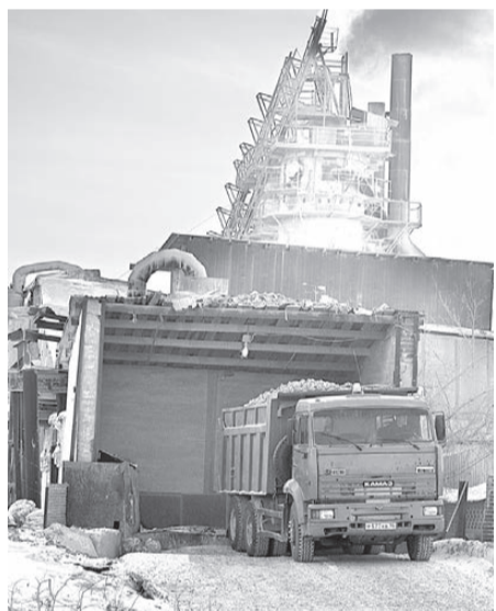
Основной продукцией предприятия является щебень различной фракции. Самосвал загружает щебень в сортировочный бункер.
