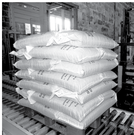
Поддоны с автоматически наполненными, зашитыми и уложенными мешками комбикормов сами выкатываются к автопогрузчику.
