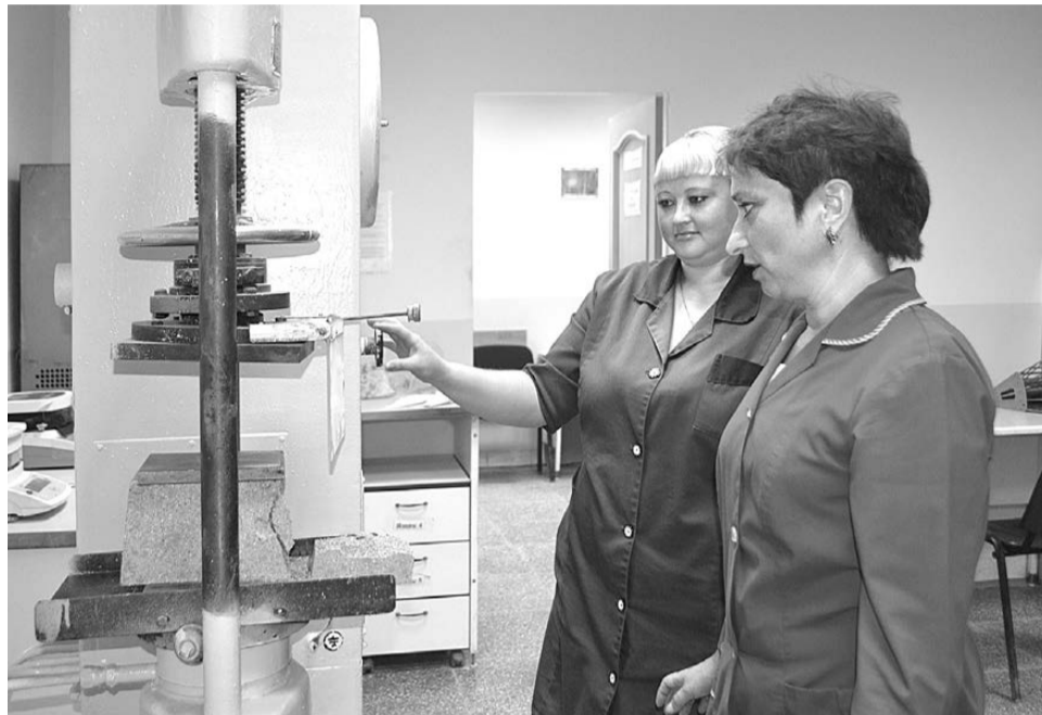
Лаборант Мария Сысолятина и Инна Гринвальд определяют предел прочности сырца при сжатии.
