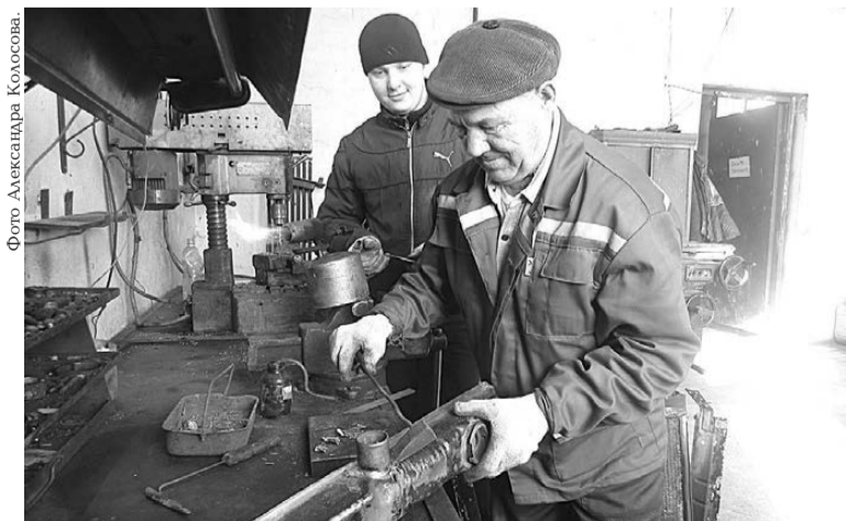
Пайку радиатора ведут специалисты Тыгишского МТМ С.В. Попов и М.И. Перескоков.
