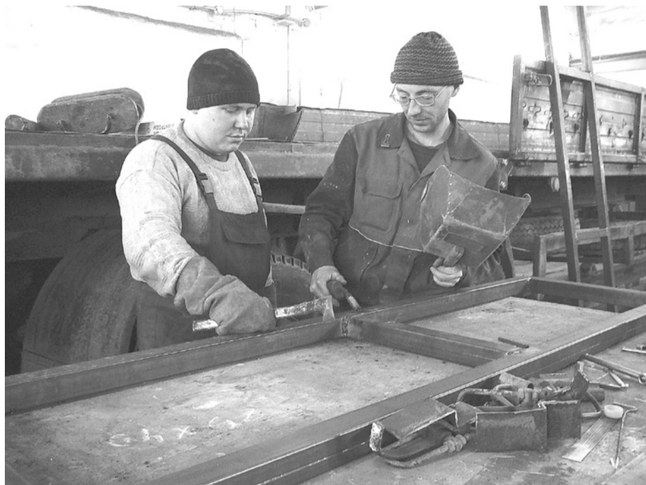
Сварку борта полуприцепа осуществляют работники ОАО «Транспорт» П.В. Быков и В.В. Флягин.
